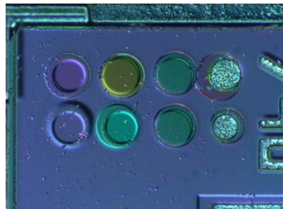
• Halbleiter, Hellfeld mit differentiellem Interferenzkontrast DIC, 50x Plan-Fluor.
