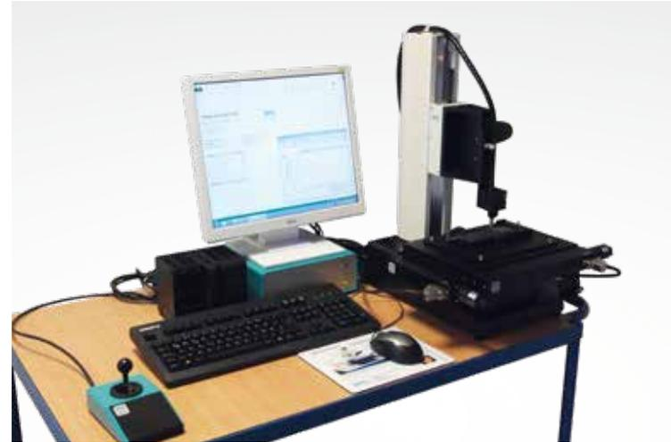
Topographiemessgerät nach Kundenspezifikation
